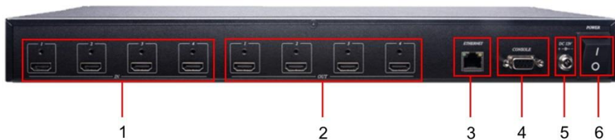
Рис.3 Разъемы подключения, кнопки задней панели коммутатора НМ44
