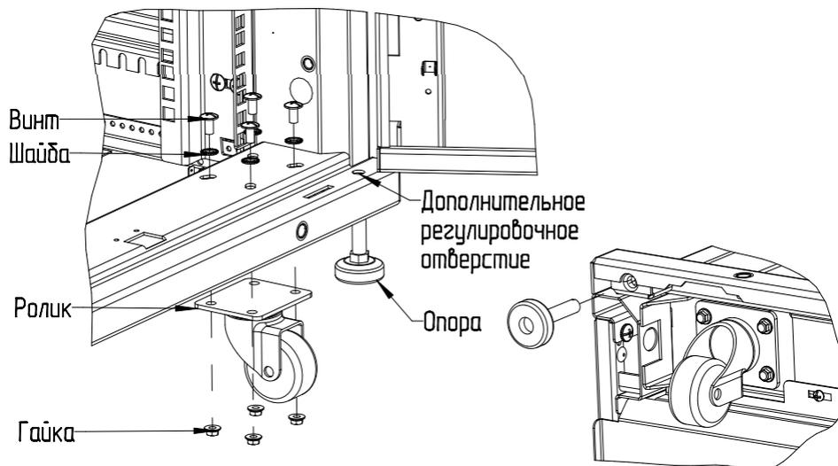
Рисунок 9. Демонтаж ножек и роликов шкафа Rackcenter D9000
