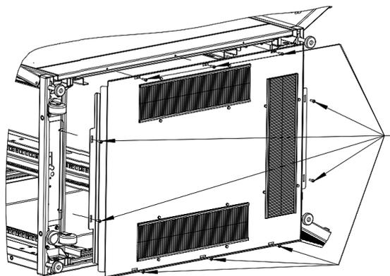
Рисунок 8. Демонтаж фальшпола шкафа Rackcenter D9000
