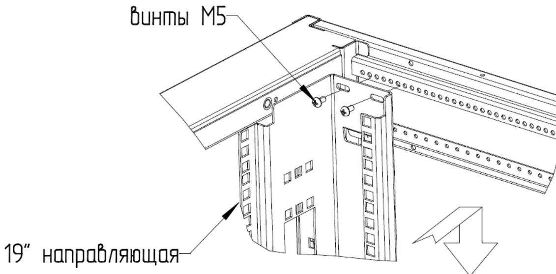
Рисунок 10. Регулировка вертикальных 19" направляющих
