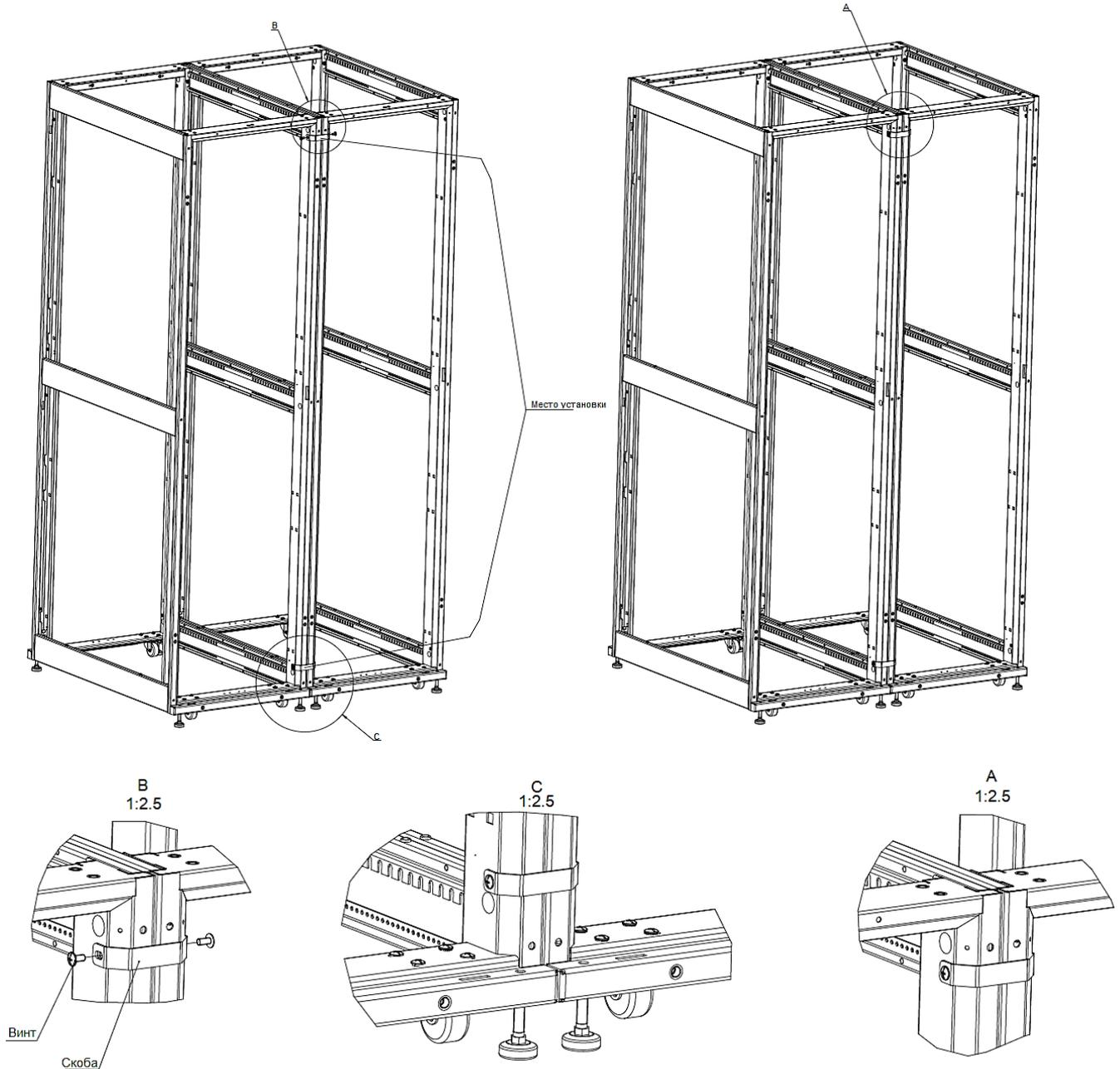
Рисунок 5. Скрепление шкафов Rackcenter D9000 в ряды
