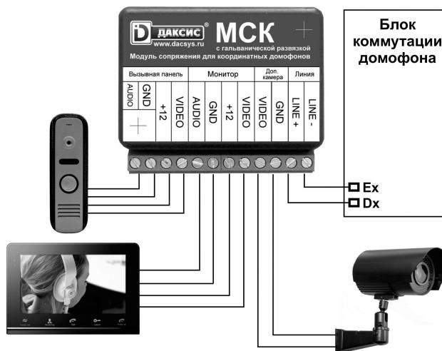
**Внимание:** Не производите подключение модуля сопряжения при включенном питании видеодомофона.
