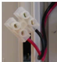
Рисунок 10. Клеммы для подключения замка к блоку питания
