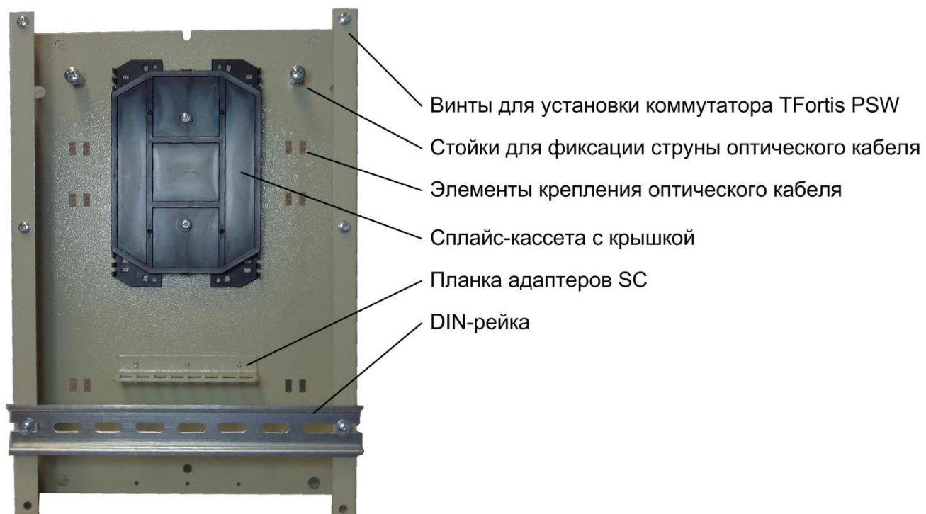
Рисунок 2.2.1 - Оптический кросс
