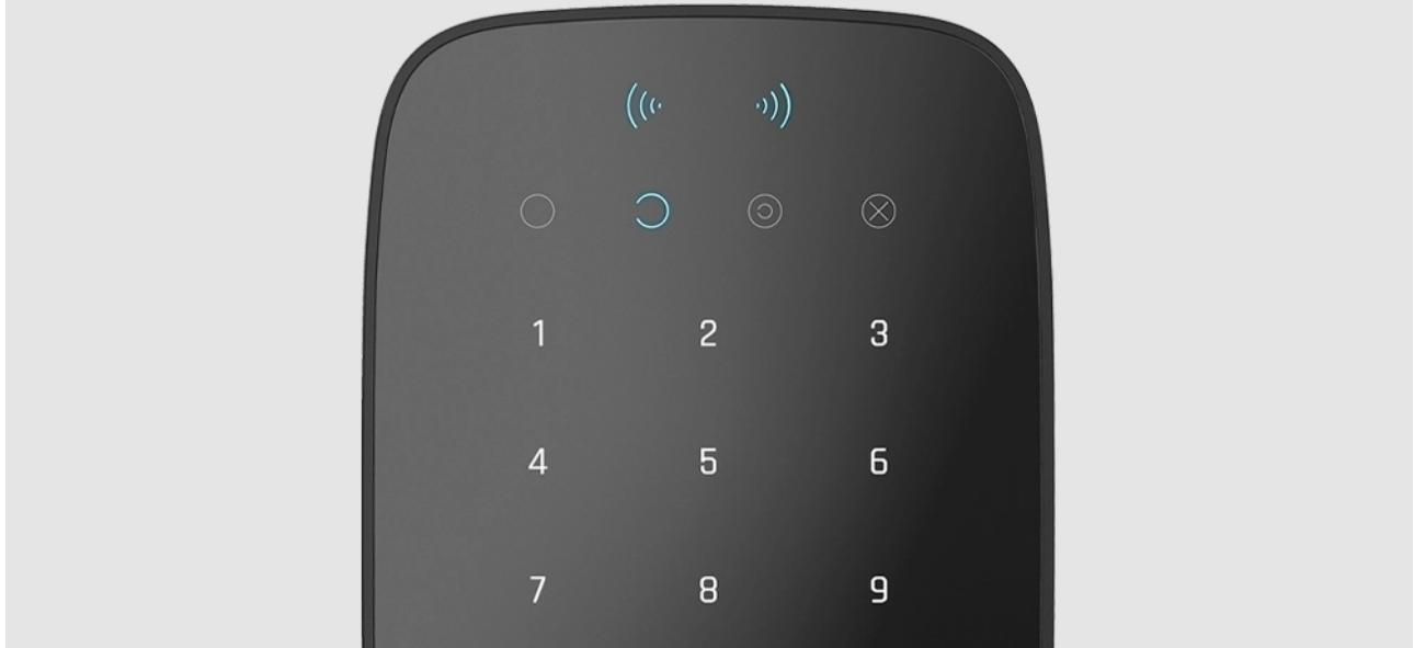
Использовать KeyPad Plus можно без внешнего освещения — у клавиатуры есть подсветка. Нажатие кнопок сопровождается звуковым сигналом. Яркость подсветки и громкость клавиатуры регулируются в настройках. Если не касаться клавиатуры 4 секунды, KeyPad Plus снизит яркость подсветки, а еще через 8 секунд перейдёт в режим энергосбережения и отключит индикацию.
