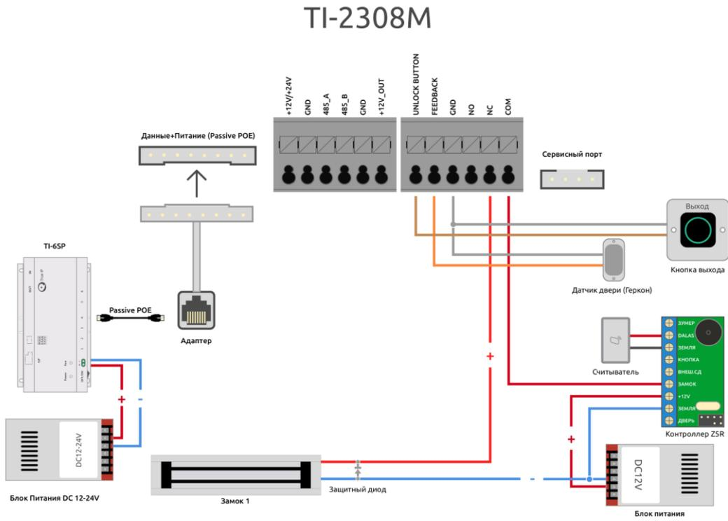
Схема подключения с использованием TI-6SP и TI-1SR (2 прохода).
