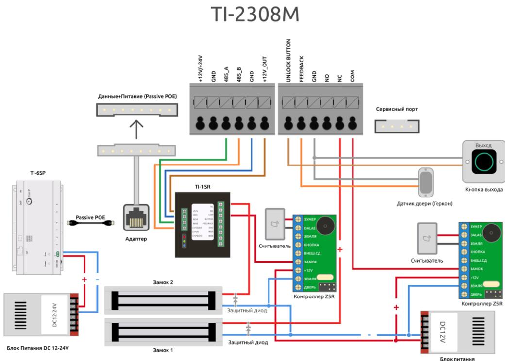
Схема подключения с использованием БП DC12-24V (1 проход).
