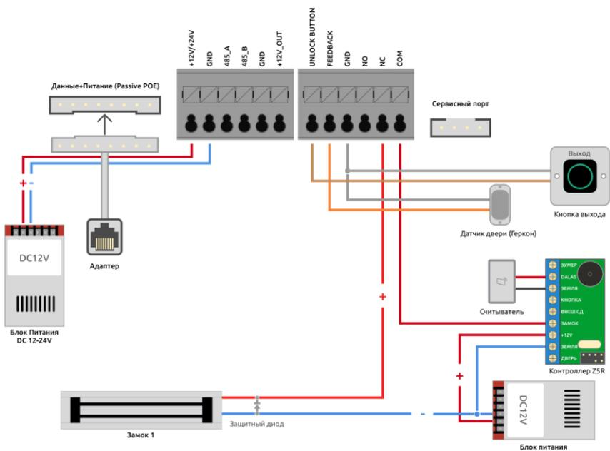
Схема подключения с использованием БП DC12-24V и TI-1SR (2 прохода).
