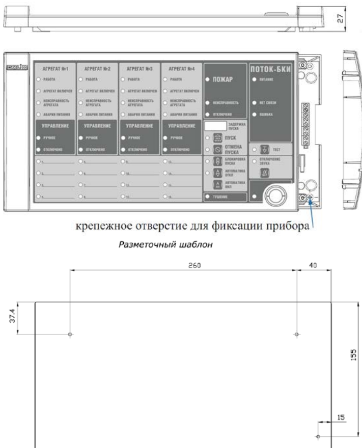
Рисунок 1. Внешний вид, габаритные и установочные размеры блока «Поток-БКИ»
