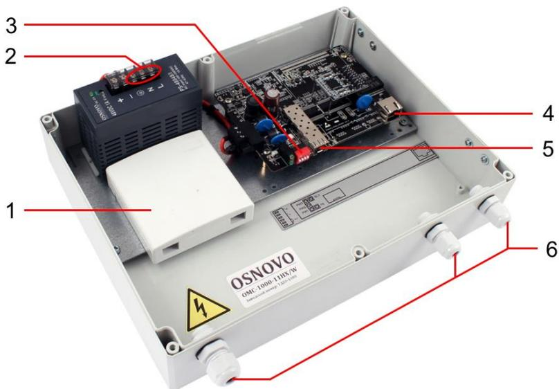
Рис. 2 Медиаконвертер OMC-1000-11HX/W, вид внутри
