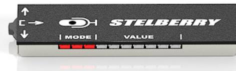
В этом режиме можно ослабить одну из заданных частот до 20 дБ ( до 10 раз). Для входа в режим необходимо нажать на джойстик, чтобы в индикации режима MODE появилась следующая комбинация ●●●
