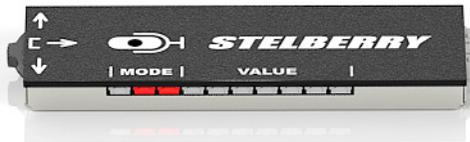
Выходная АРУ отключена. В зоне индикации VALUE не светится ни один светодиод.
