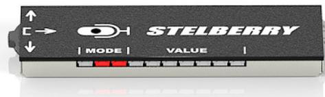
В этом режиме можно включить или отключить выходную АРУ и установить скорость срабатывания выходной АРУ. Для входа в режим необходимо нажать на джойстик, чтобы в индикации режима MODE появилась следующая комбинация ○●●
