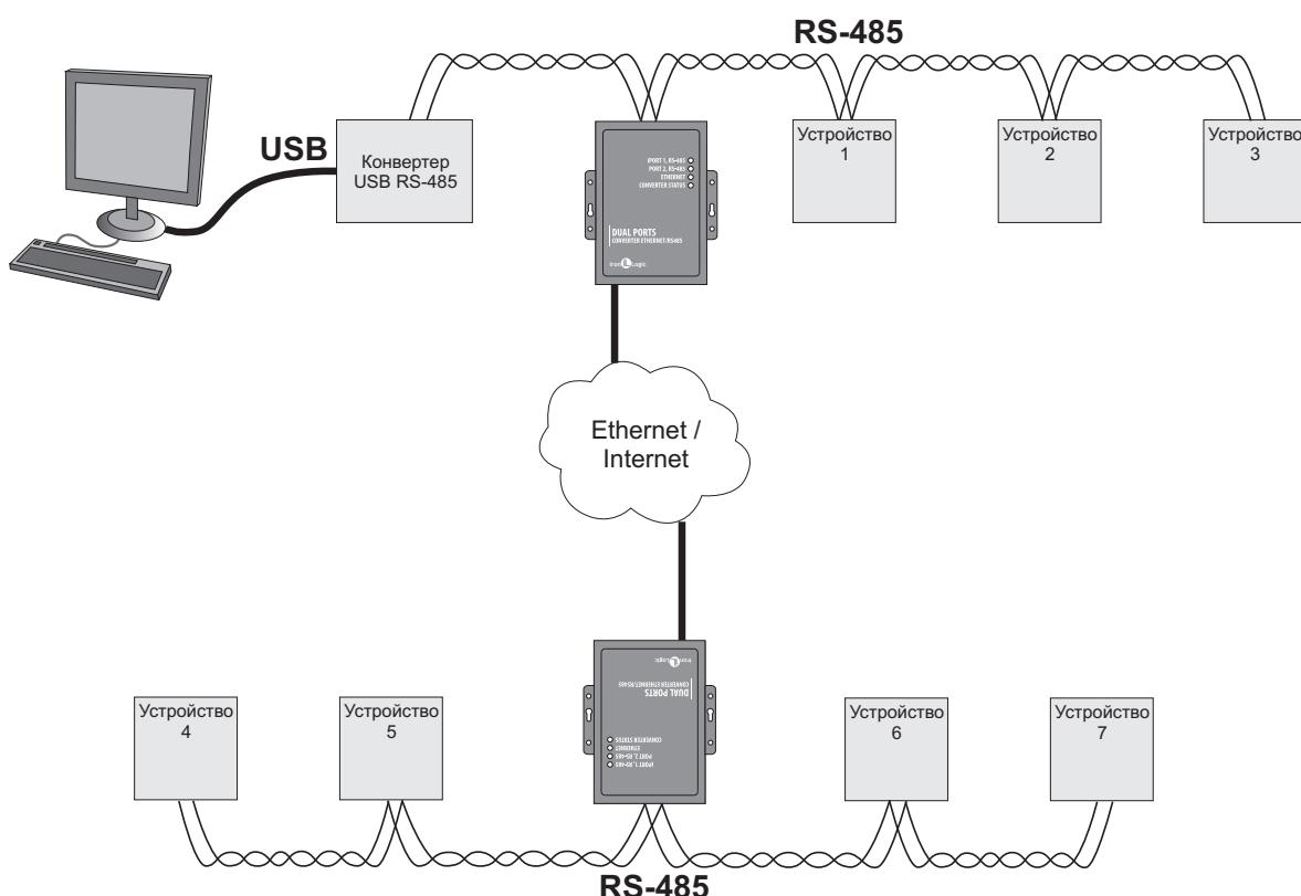
Пример конфигурации конвертеров для режима моста:
