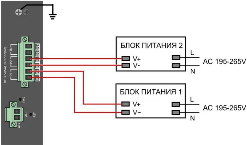
Рис.8 Схема подключения блоков питания к клеммной колодке коммутаторов SW-80804/ILS(port 90W 300W) и SW-80804/ILS(port 90W 720W)
