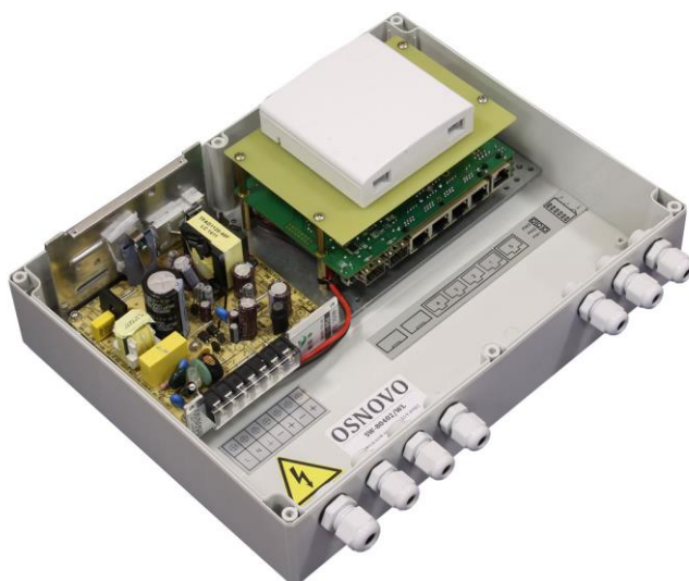
Рис. 2 Уличный коммутатор SW-80402/WL, внешний вид внутри
