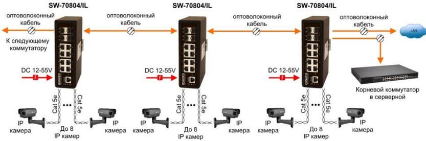
Рис.6 Типовая схема подключения коммутатора на примере SW-70804/IL
