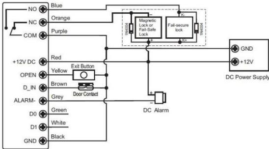
**Внимание:** Установка 1N4004 или аналогичного диода необходима при использовании общего источника питания, в противном случае может быть поврежден считыватель. (1N4004 входит в упаковку)
