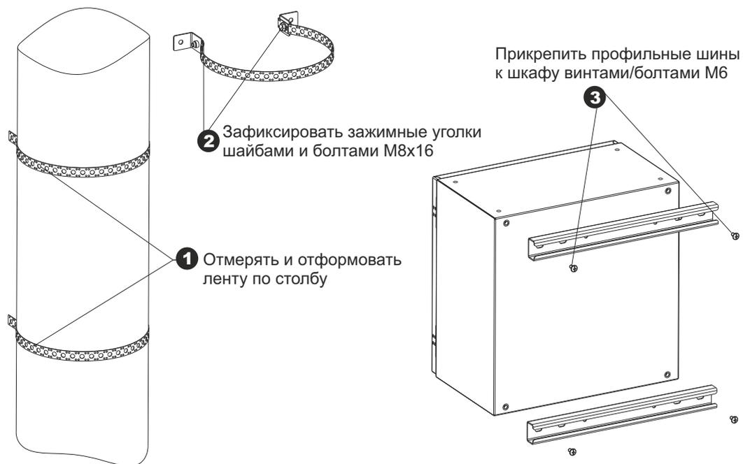
4 В кронштейны крепления ввинтить до упора болты М8х40
