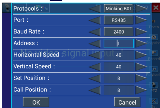
Рис.3.3.1-2 Окно настройки протокола управления камерой (RS485)
