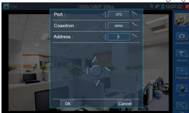
Рис.3.3.6.-5 Установка параметров протокола Coaxitron
