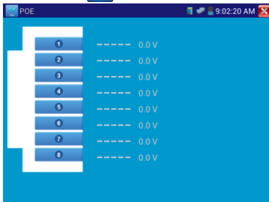
Рис. 3.3.21-1 Напряжение PoE на линиях кабеля витой пары
