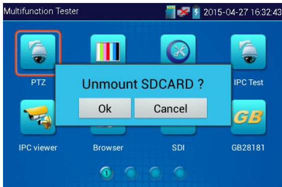
Рис. 3.3-2 Приглашение демонтировать флеш-карту
