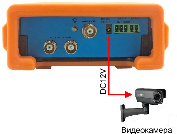
Рис. 7 Подключение питания к IP-видеокамере
