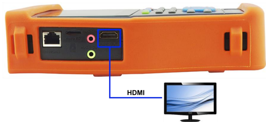
Рис. 11 Подключение тестера к HDMI-монитору
