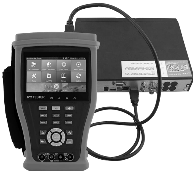
Рис. 10 Подключение HDMI устройств к тестеру.
