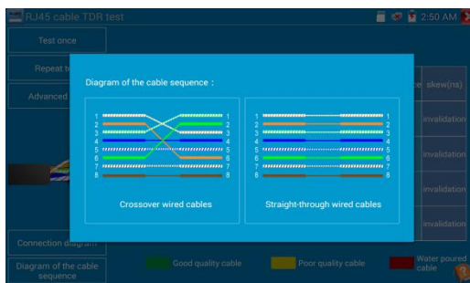
Рис. 105 Типы обжимки кабеля «витой пары»
