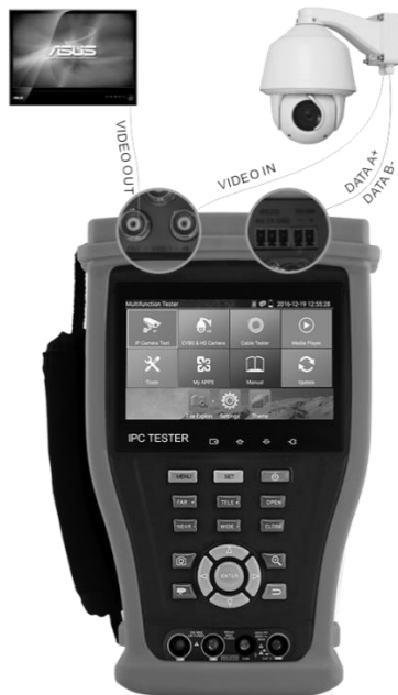
Рис. 8 Подключение CVBS видеокамеры к тестеру
