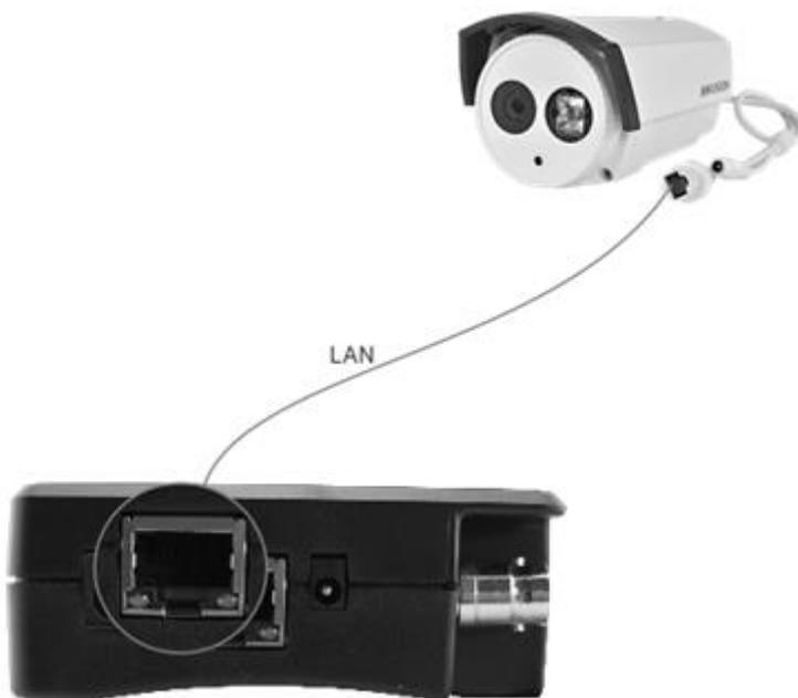
Рис. 8 Подключение IP-видеокамеры к тестеру
