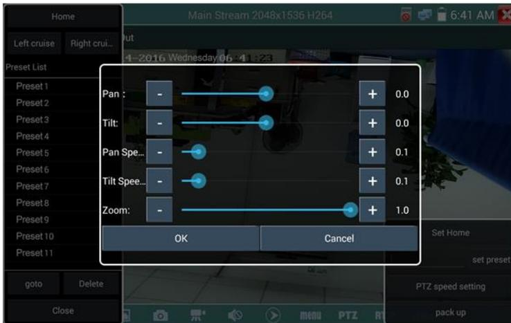
Рис. 50 Настройки горизонтальной и вертикальной скорости PTZ
