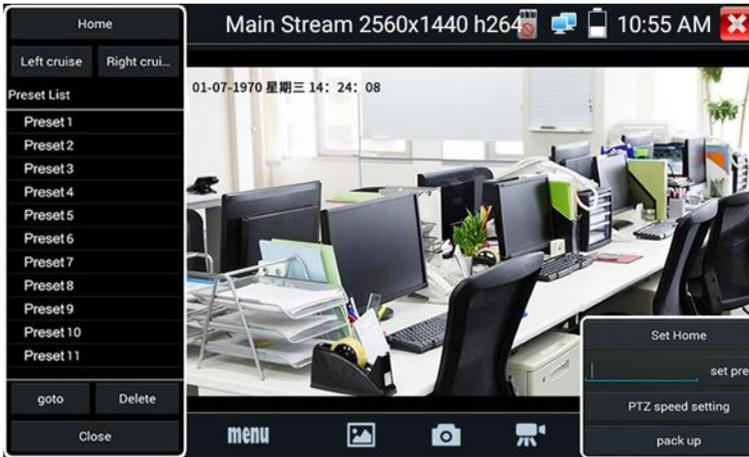
Рис. 49 Пресеты для управления PTZ IP видеокамерой
