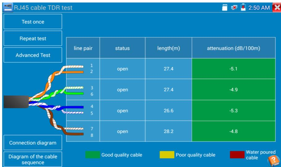
Рис. 100 Интерфейс рефлектометра (TDR) для кабеля «витой пары»
