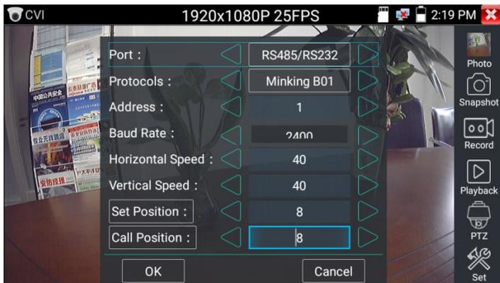
Рис.77 Управление PTZ CVI видеокamerой по интерфейсу RS232/485
