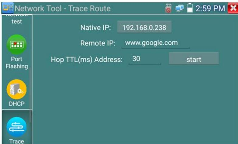
Рис. 95 Интерфейс инструмента «Трассировка маршрута» (Trace Route)
