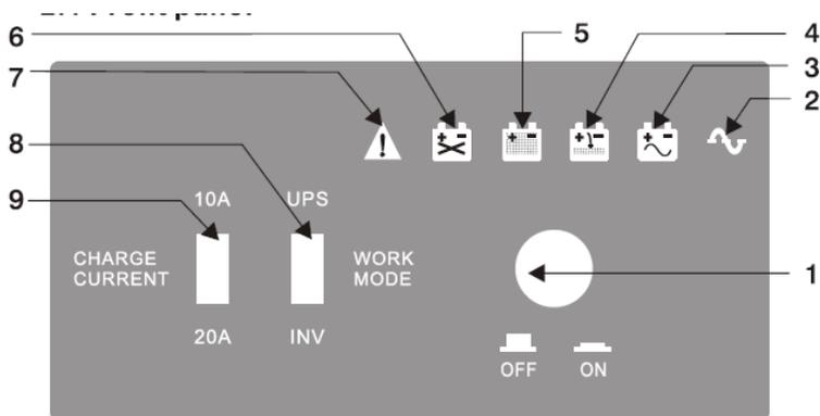
Рисунок 4-1-1. Передняя светодиодная панель инвертора на 600
