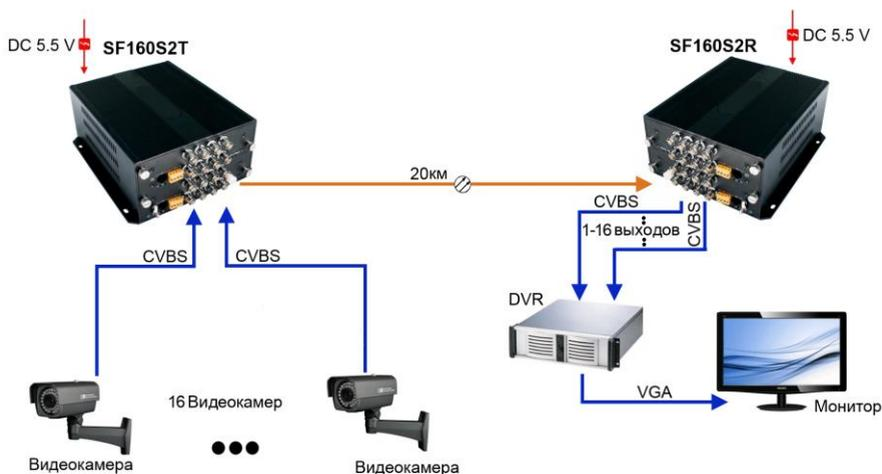
Рис. 7 Схема подключения оптических передатчиков SF160S2T(приемников SF160S2R)
