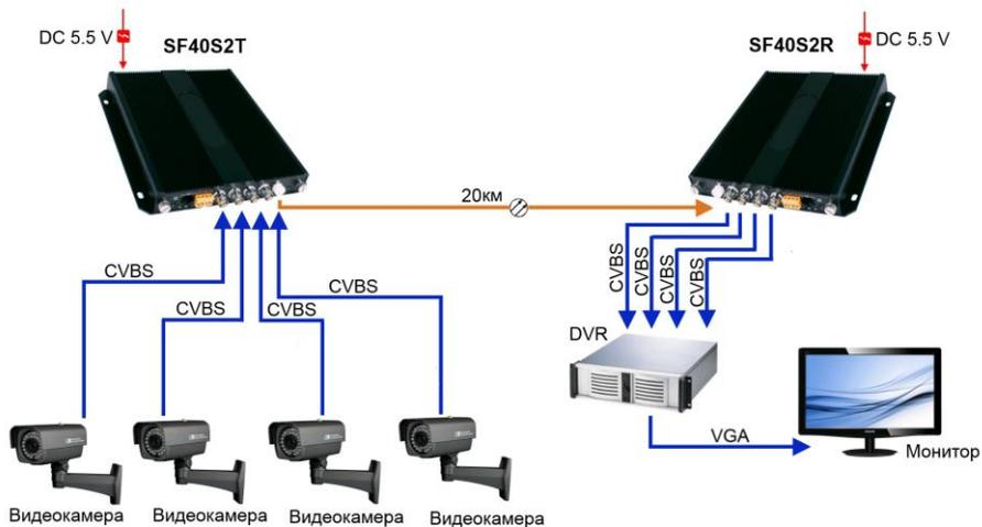
Рис. 5 Схема подключения оптических передатчиков SF40S2T и приемников SF40S2R
