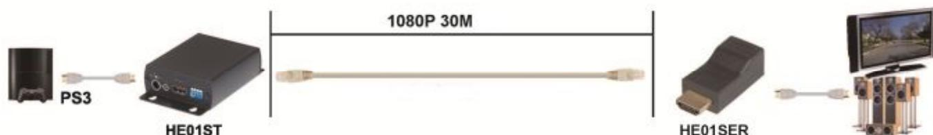
Рис.5 Схема подключения передатчика HE01ST и приемника HE01SER
