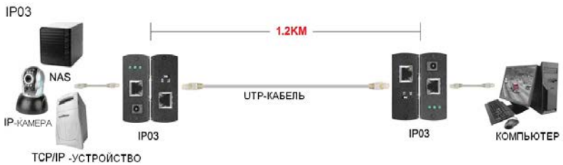
Рис.4 Схема подключения IP03
