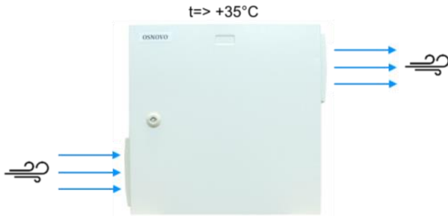
Рис. 29 Принцип работы системы проточной вентиляции
