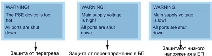
Рис. 7 Дополнительная информация на TFT-дисплее коммутаторов SW-61622/TB, SW-61622/TB(330W), SW-62422/TB
