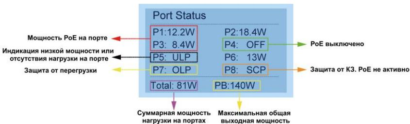
Рис. 6 Информация на TFT-дисплее коммутаторов SW-61622/TB, SW-61622/TB(330W), SW-62422/TB\*
