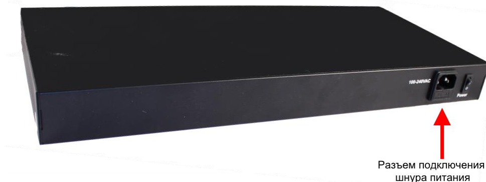
Рис. 6 Коммутатор SW-62422/B(330W), разъемы на задней панели
