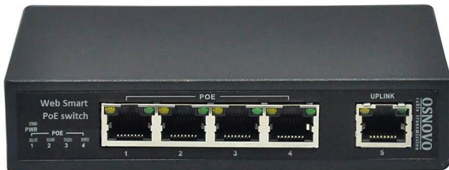
Рис.1 Коммутатор SW-20500/MB(60W), внешний вид
