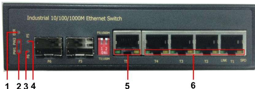
Рис.4 LED-индикаторы коммутатора SW-7052/1
