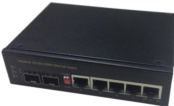
Рис.1 Коммутатор SW-7052/I, внешний вид
