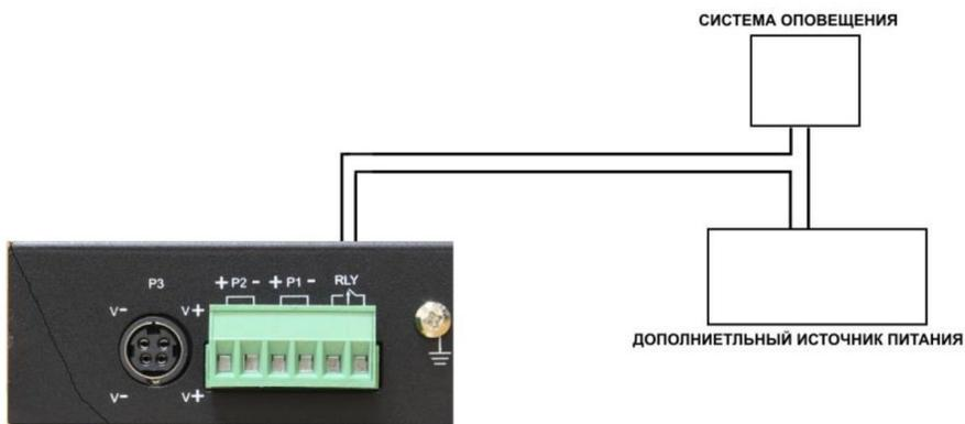
Рис.5 Схема подключения системы оповещения к коммутатору SW-7052/I
