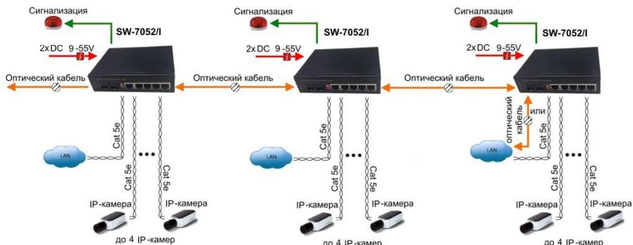
Рис.7 Типовая схема подключения коммутатора SW-7052/I
